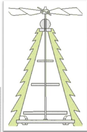
Alle Teile sind entsprechend der unten aufgeführten Stückzahl aus Sperrholz (empfohlen wird Birkensperrholz) sauber auszusägen, die Bohrungen und Aussparungen einzubringen und zu verschleifen. Die Maße für die einzelnen Teller sind ebenfalls der unten aufgeführten Stückliste zu entnehmen. Die Montage der Pyramide erfolgt von unten nach oben.
